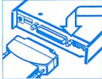
TIGHTEN THE SCREW CONNECTORS ONCE THE END OF THE CABLE HAS BEEN PROPERLY INSERTED.
